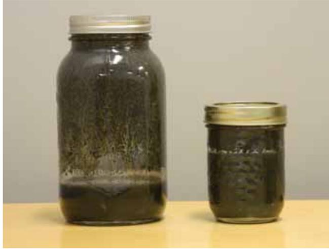
**Figure 4.5.2.** Les eaux de ruissellement peuvent transporter de nombreux contaminants (débris de pneus, pétrole, huiles de cuisson, poussières et métaux). Ces pots contiennent des produits des eaux de ruissellement recueillies dans un désableur-déshuileur d'un secteur commercial du Nord de l'Ontario. Si l'on ne nettoie pas les désableurs-déshuileurs, ces produits feraient leur chemin jusque dans les lacs et les rivières.
