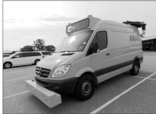
Figure 9 : Véhicule avec outil d'auscultation automatisée de l'état des routes
