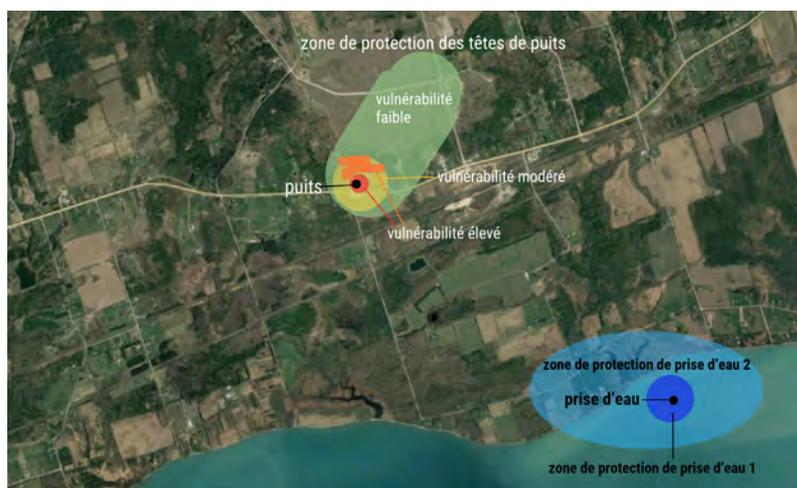
**Figure 2.** Zones vulnérables qui nécessitent une protection spéciale contre les menaces à l'eau potable. De manière générale, les zones les plus près d'une tête de puits ou des prises d'eau en surface sont les plus vulnérables.
